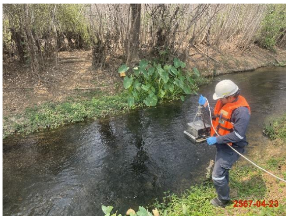
รูปที่ ง-3.5 การเก็บตัวอย่างตะกอนดินจากแหล่งน้ำทิ้งที่ผ่านระบบบำบัดชีววิธี ก่อนระบายลงสู่อ่างเก็บน้ำแม่เมาะ (เมื่อวันที่ 23 เมษายน 2567)
