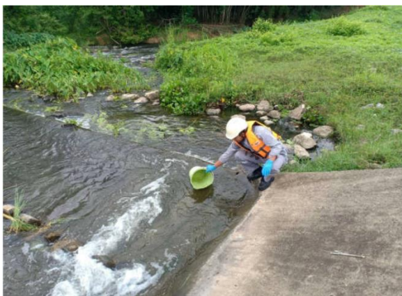
รูปที่ ง-3.3 การเก็บตัวอย่างน้ำทิ้ง บริเวณน้ำทิ้งที่ผ่านระบบชีววิธี ก่อนระบายลงสู่อ่างเก็บน้ำแม่เมาะ (เดือนมกราคม-มิถุนายน 2567)
